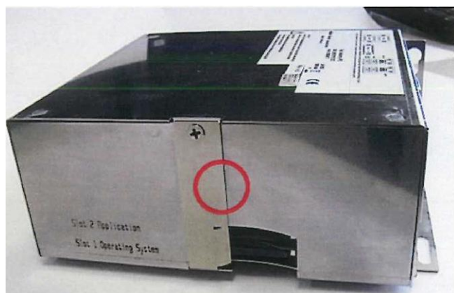
Рисунок 9 - Место пломбировки слота карты памяти терминалов C35XY, CM35XY, CX35XY, CV35XY для защиты от изменения ПО
