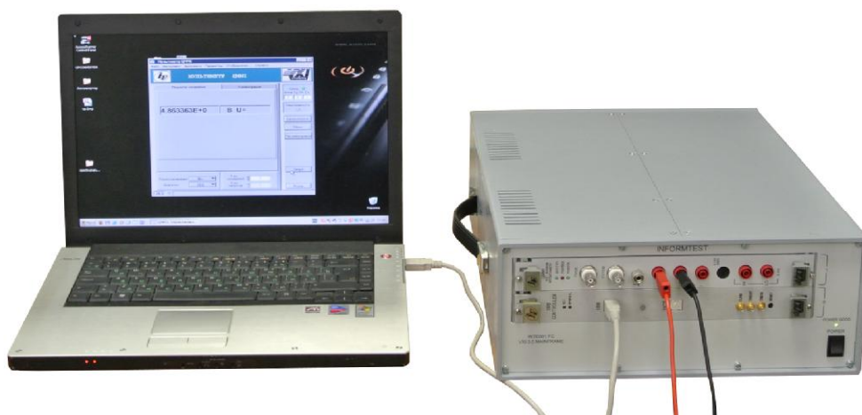
Рисунок 2 – Общий вид рабочего места оператора с установленным в базовый блок мультиметром
