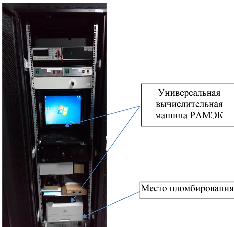
Рисунок 2 – Общий вид устройства управления, хранения и обработки измерительной информации в составе комплекта аппаратуры СПЭЯ, СПСИ, СПЭО со схемой пломбировки
