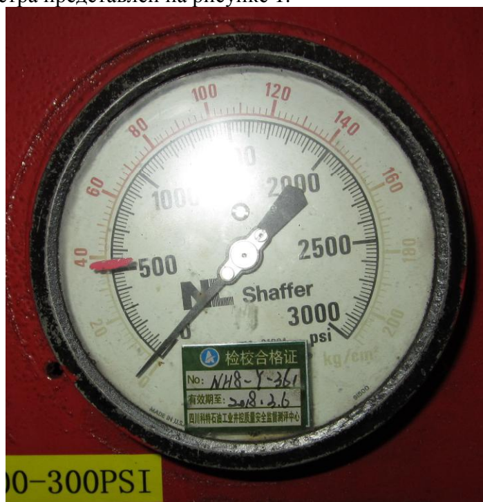
Рисунок 1 – Внешний вид манометра деформационного показывающего 100FIA44A21C
