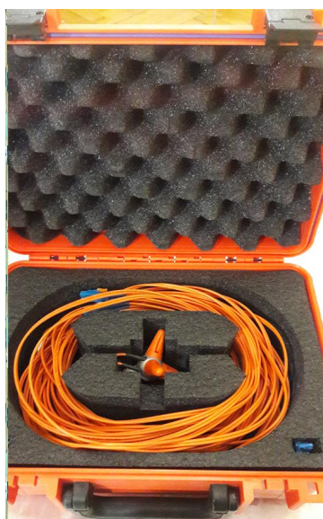
Рисунок 2 – Внешний вид пробника поля FL7006 и волоконно-оптического кабеля в кейсе для переноски
