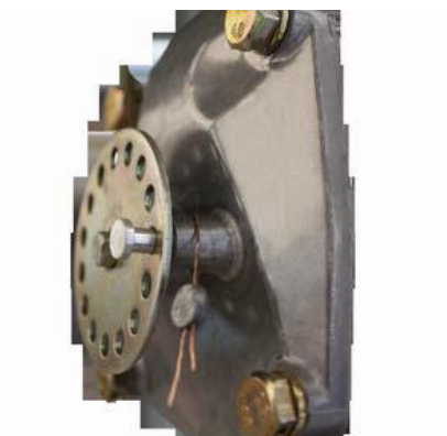
Рисунок 3 – Пломбировка регулировочного винта измерителя объёма
