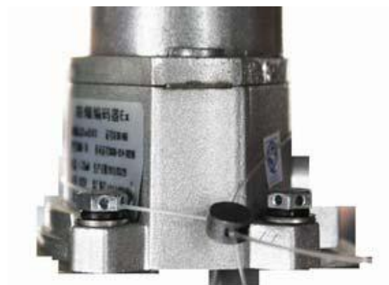
Рисунок 4 – Пломбировка датчика импульсов
