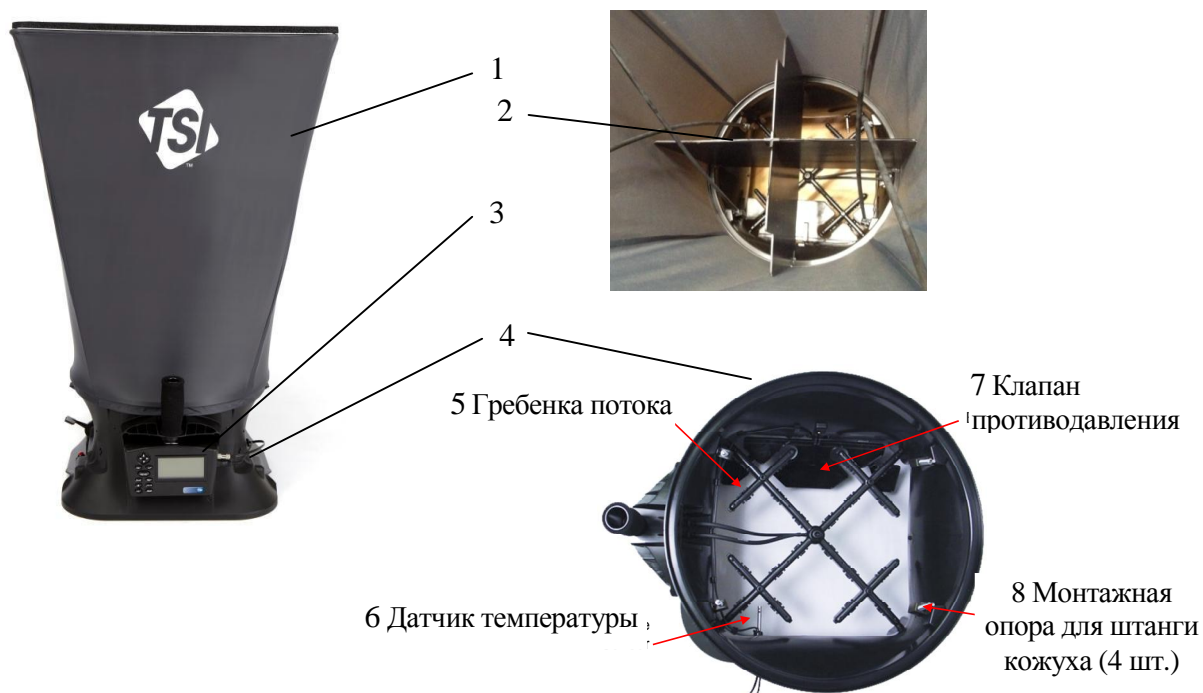
Рисунок 1 – Общий вид расходомера и его основания
