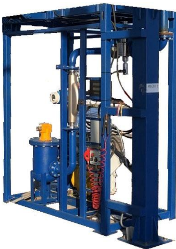
Рисунок 2 – АТНК-МХХХЭ Исполнение с массомером Promass 83F
