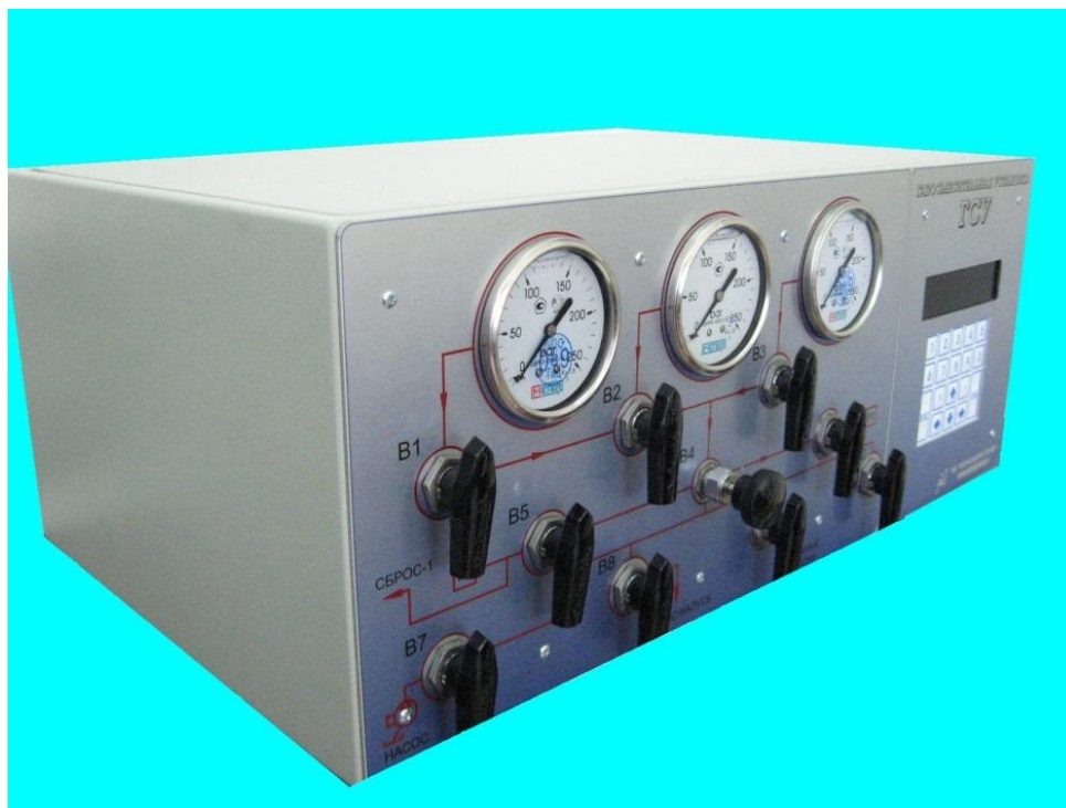
Рисунок 1 – Общий вид газосмесительной установки ГСУ
