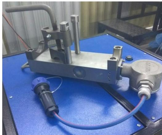
Рисунок 1 - Общий вид датчиков натяжения ТСЕ–100К.
