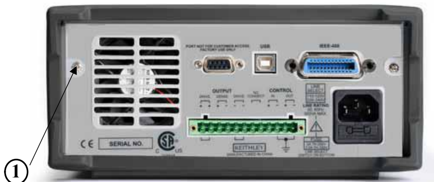
Рисунок 6 - Источник питания 2200-60-2, вид сзади ① - место для нанесения оттиска клейма или размещения наклейки
