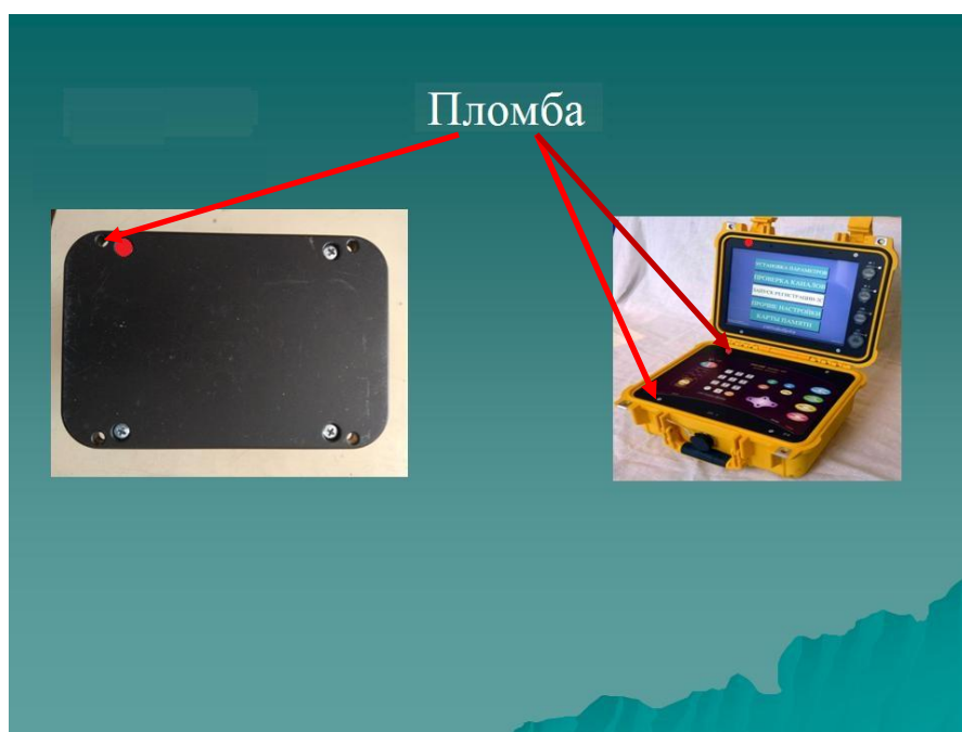
Рисунок 2 – Схема пломбировки от несанкционированного доступа
