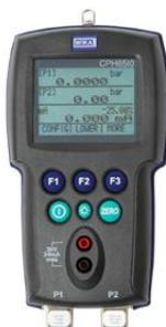
Рисунок 6 – Общий вид калибраторов CPN6510-S1, CPN6510-S2
