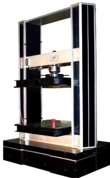
Рисунок 6 – Общий вид машины испытательной универсальной электромеханической 3R, исполнения SINTIUM
