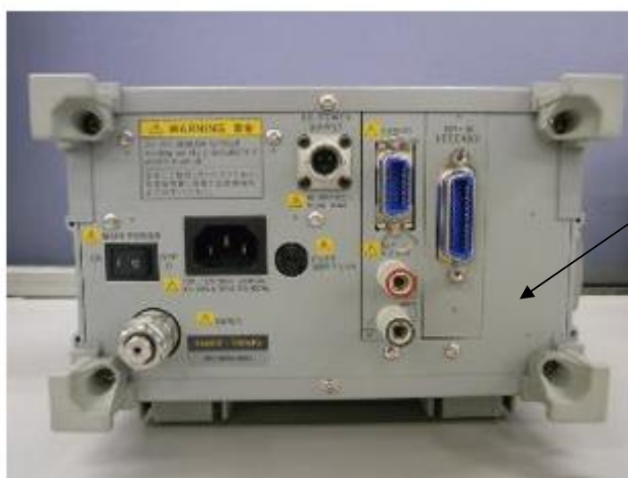
Рисунок 4 – Схема нанесения знака поверки
