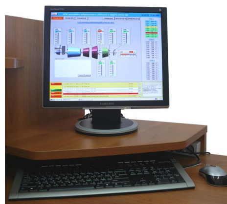
Рисунок 4 - Автоматизированное рабочее место оператора (АРМ)
