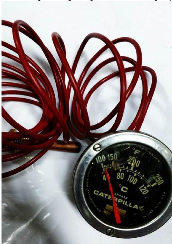
Рисунок 1 - Общий вид термометров манометрических 3N4428
