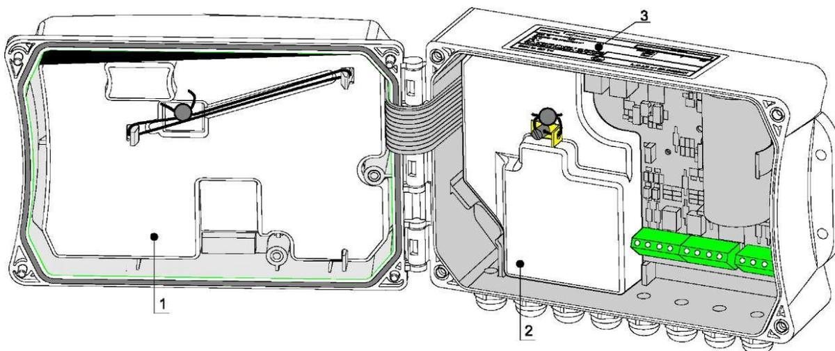
Рисунок 2 – Места нанесения клейм (наклеек и пломб)
