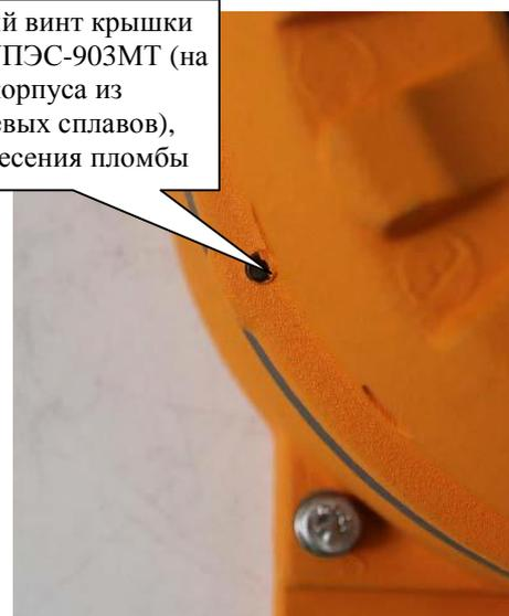
Рисунок 4 – Схема опломбирования газоанализаторов от несанкционированного доступа
