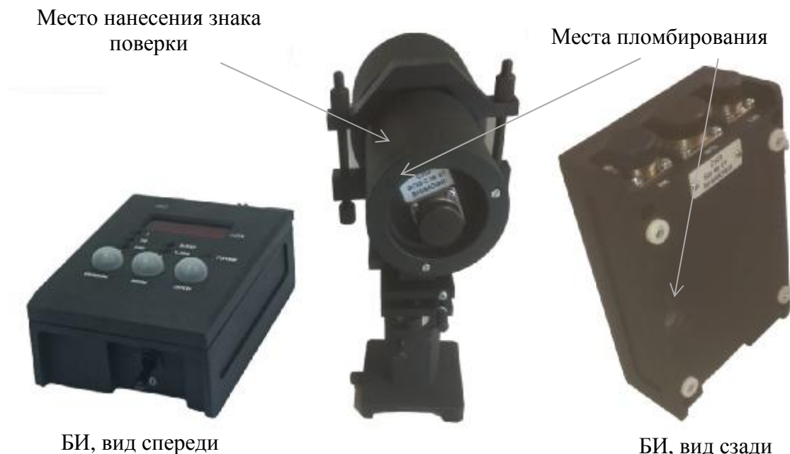
Рисунок 2 - Схема пломбировки от несанкционированного доступа, обозначение нанесения знака поверки
