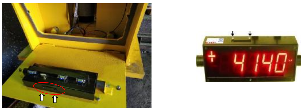
Рисунок 2 - Схема пломбировки от несанкционированного доступа.
