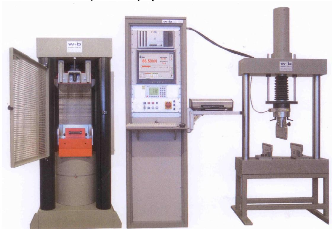
Рисунок 1 - Общий вид машины для испытаний строительных материалов LF-D-3000kN-S/LF-DBZ-200kN
