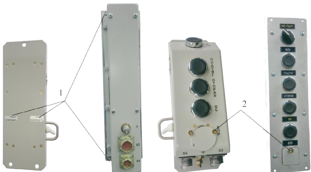
Рисунок 1 – Общий вид и схема пломбировки от несанкционированного доступа ПУ-САУТ-ЦМ/485 при выпуске из производства (1) и при вводе в эксплуатацию (2)
