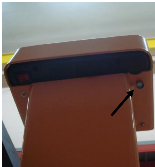
Рисунок 4 - Схема пломбировки от несанкционированного доступа.
