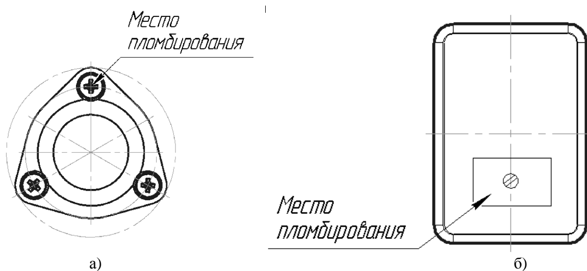
Рисунок 2 – Схема пломбирования газоанализаторов ГАСБМ а) модель ГАСБМ-XX; б) модель ГАСБМ-PI
