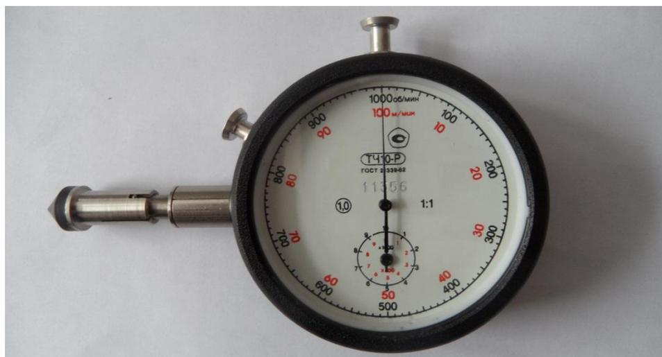
Рисунок 1- Общий вид тахометра часового ТЧ10-Р
