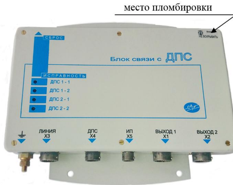
Рисунок 1 – Общий вид и схема пломбировки от несанкционированного доступа БС-ДПС
