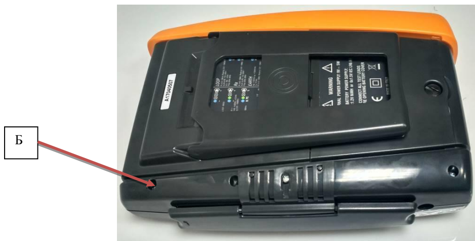
Рисунок 2 – Схема пломбировки от несанкционированного доступа (Б).
