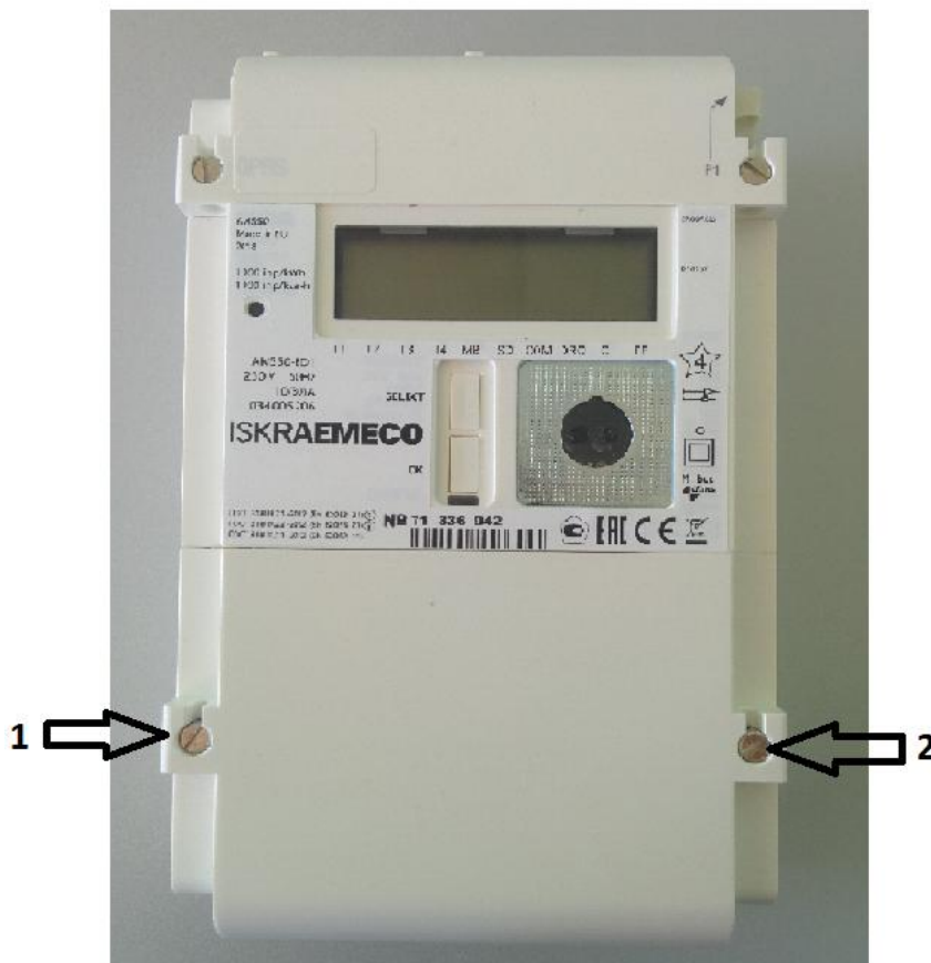
Рисунок 2 - Схема пломбировки от несанкционированного доступа (1) и обозначение места нанесения знака поверки (2) на счетчики
