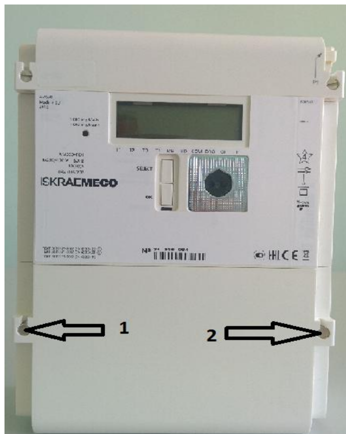
Рисунок 2 - Схема пломбировки от несанкционированного доступа (1) и обозначение места нанесения знака поверки (2) на счетчики
