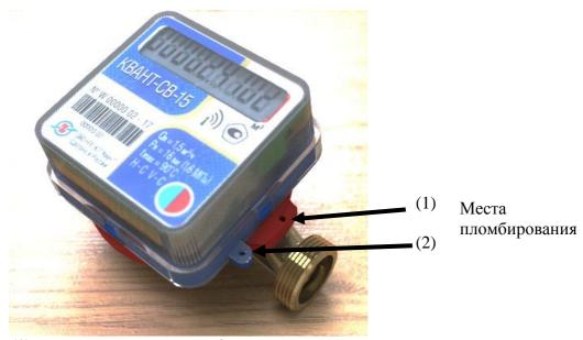
(1) - место нанесения пломбы на механическую часть счетчика (2) - место нанесения знака поверки на пломбу электронного блока счетчика
