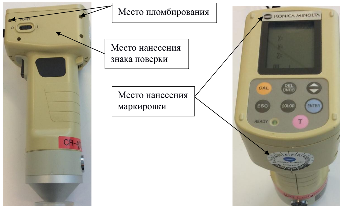
Рисунок 1 - Общий вид компараторов с обозначением мест нанесения маркировки, знака поверки, схемой пломбировки от несанкционированного доступа
