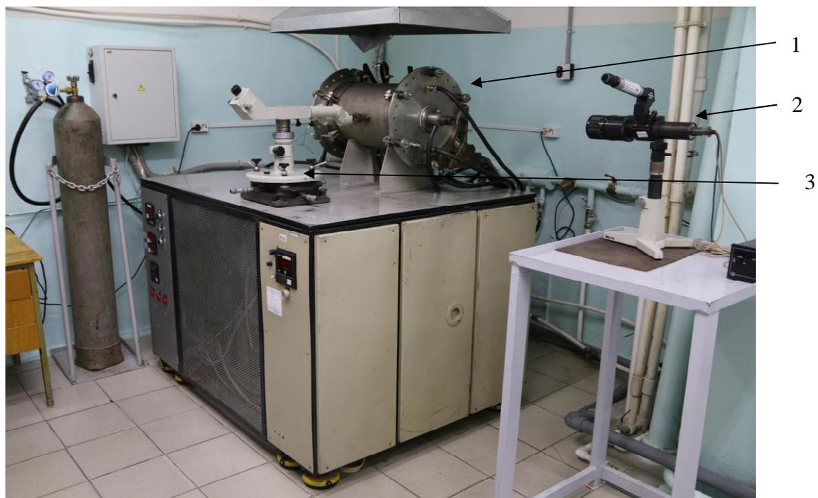
Рисунок 1 – Общий вид дилатометра ВД-1 № 001
