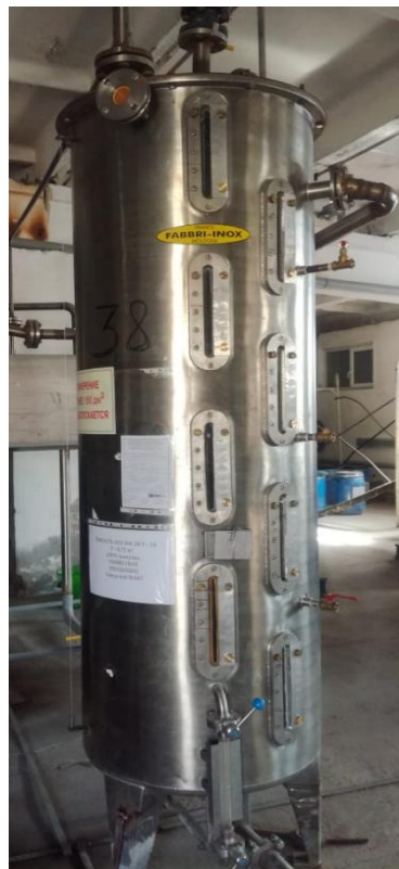
Рисунок 1 - Общий вид мерника металлического технического 1 класса ММТВ
