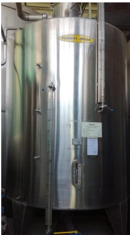
Рисунок 2 - Общий вид мерника металлического технического 1 класса ММТВ номинальной вместимостью 10 м 3
