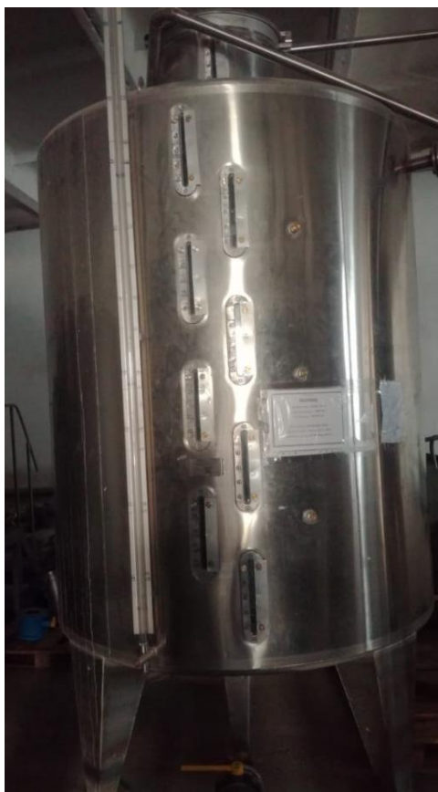
Рисунок 1 - Общий вид мерника металлического технического 1 класса ММТВ номинальной вместимостью 5 м 3
