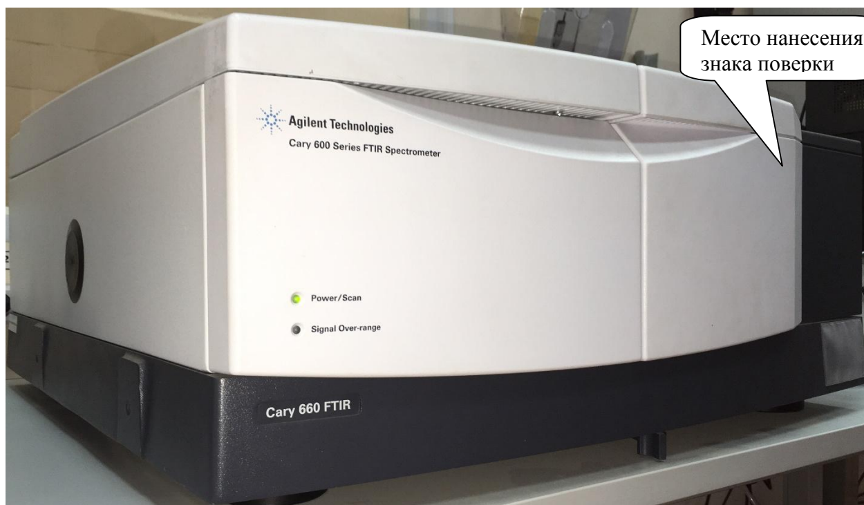
Рисунок 2 - Общий вид фурье-спектрометров инфракрасных Cary 600 Series FTIR Spectrometer (моделей 660 FTIR, 670 FTIR, 680 FTIR)
