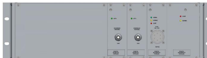
Рисунок 8 – Электронный блок ЦАП Н для вывода пропорционального аналогового сигнала 100/√3 В трансформаторов ТТНК
