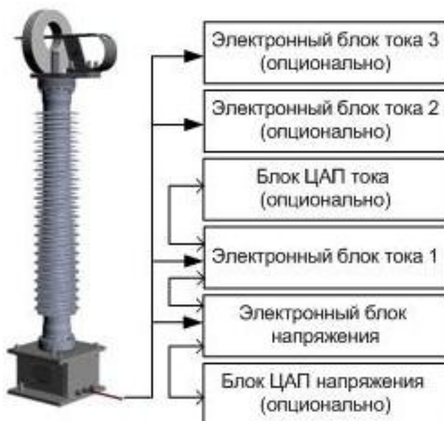
Рисунок 4 – Схема соединения блоков ТТК
