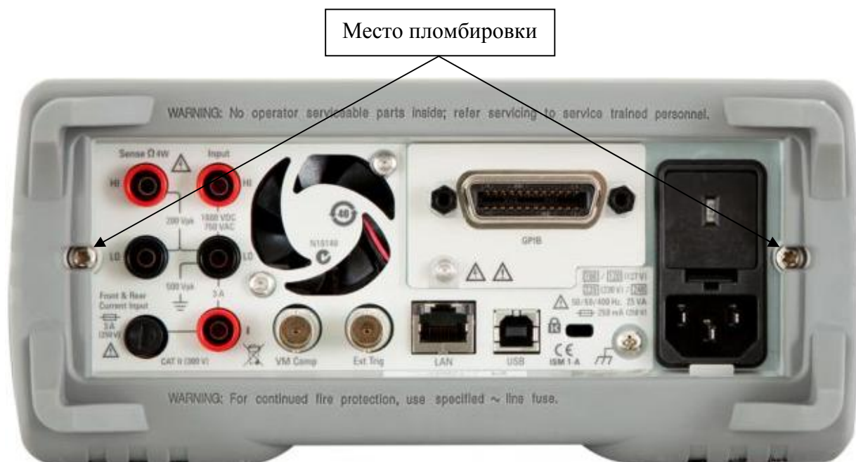
Рисунок 4 – Общий вид мультиметров цифровых 34461А. Вид сзади. Схема пломбировки от несанкционированного доступа
