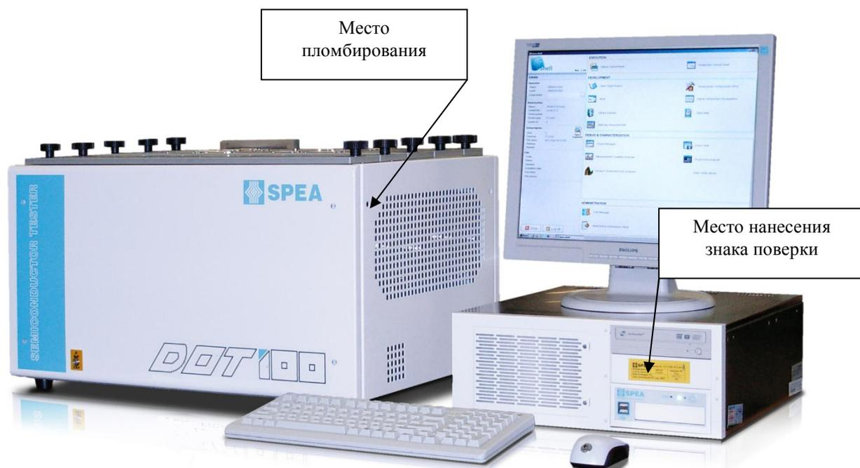
Рисунок 2 – Общий вид тестеров SPEA DOT100, места пломбирования и нанесения знака поверки
