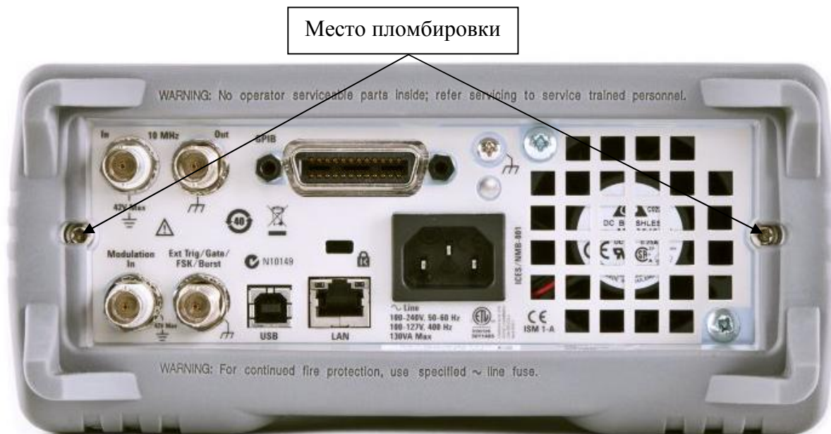
Рисунок 2 – Схема пломбировки от несанкционированного доступа
