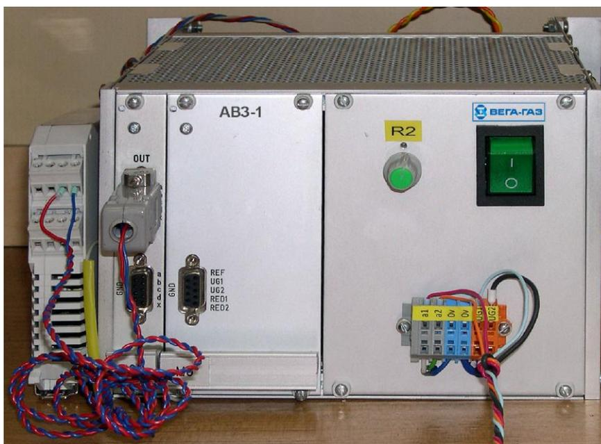
Рисунок 1 - Общий вид электронного блока аппаратуры вибрационной защиты
