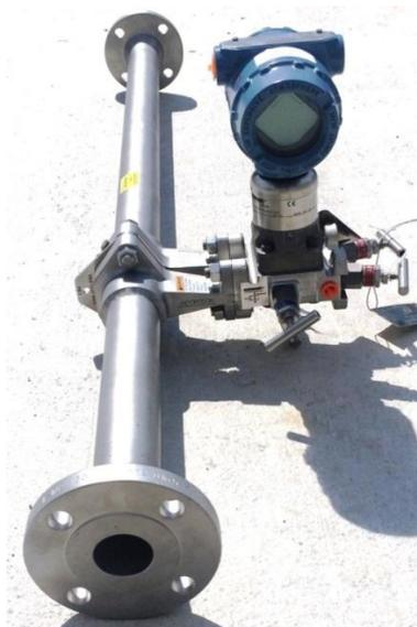
Рисунок 1 – Общий вид преобразователей разности давлений измерительных Rosemount 3051SFP
