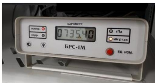
Рисунок 13 – Преобразователь давления абсолютного БРС-1М. Вид внешний
