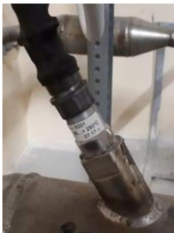
Рисунок 11 – Преобразователь температуры первичный ТПИ-9201. Вид внешний
