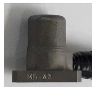
Рисунок 14 – Преобразователь виброускорения первичный МВ-43. Вид внешний
