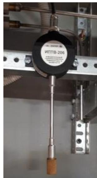
Рисунок 12 – Преобразователь влажности и температуры первичный ИПТВ-206. Вид внешний
