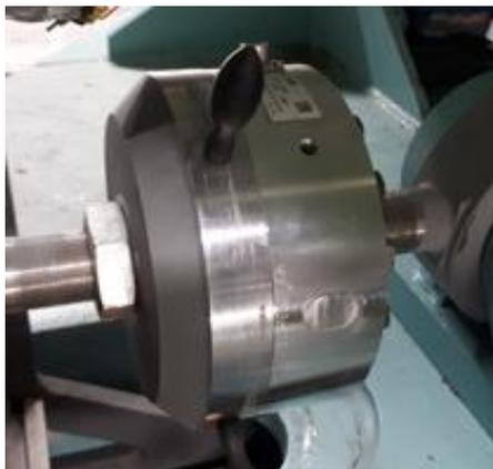
Рисунок 5 – Преобразователь силы
