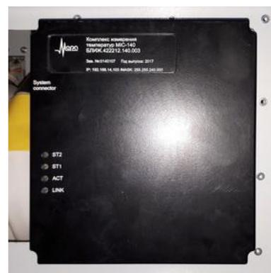
Рисунок 4 – Комплекс измерений температур МТС-140. Вид внешний
