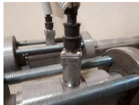
Рисунок 8 – Преобразователь расхода
