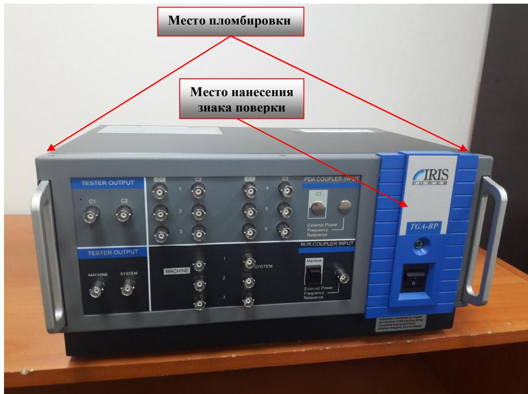
Рисунок 6 - Общий вид систем TGA-BP
