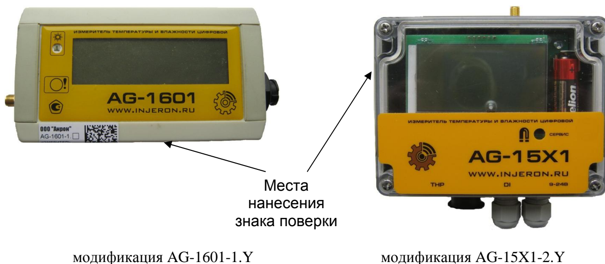
Рисунок 2 – Общий вид средства измерений и обозначения мест нанесения знака поверки для модификаций AG-1601-1.Y и AG-15X1-2.Y
