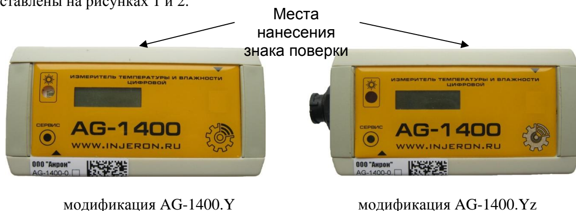
Рисунок 1 – Общий вид средства измерений и обозначения мест нанесения знака поверки для модификаций AG-1400 и AG-1400.Yz
