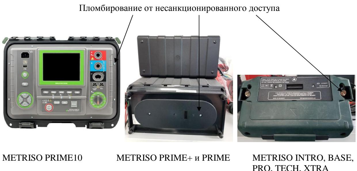
Рисунок 3 – Схема пломбирования от несанкционированного доступа METRISO модификаций PRIME, PRIME+, PRIME10, INTRO, BASE, TECH
