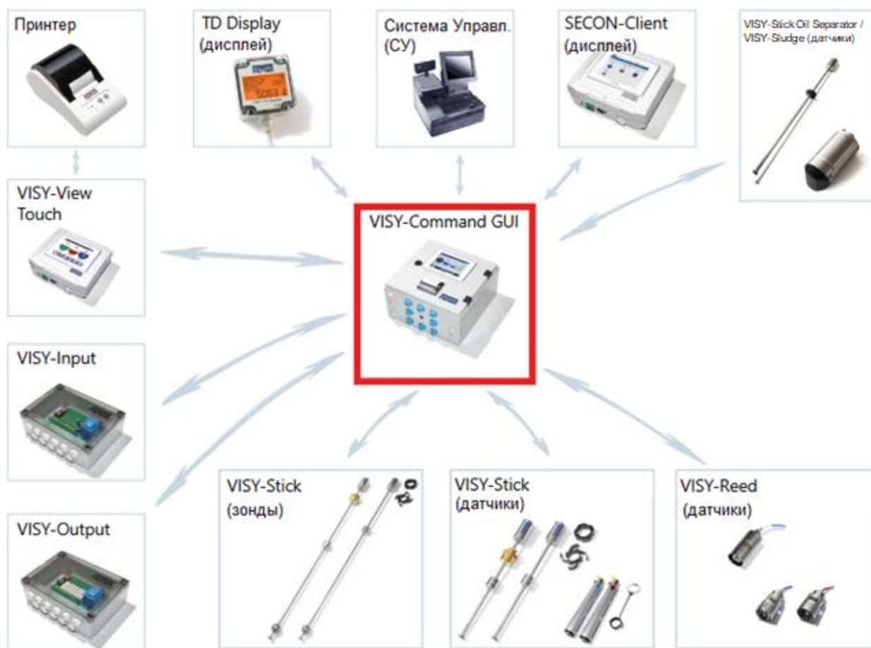
Рисунок 1 – Блок-схема подключения компонентов системы к контроллеру VISY-Command и его подтипов
