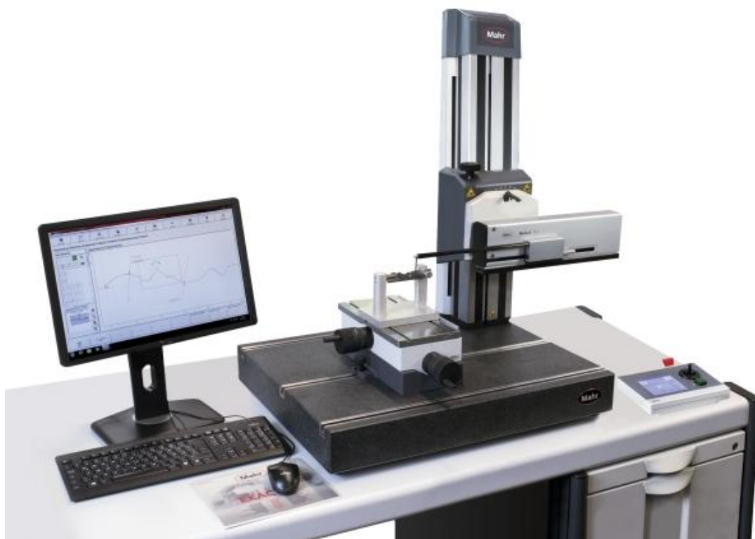
Рисунок 2 – Общий вид приборов для измерений параметров контура и шероховатости поверхности MarSurf XC 20
