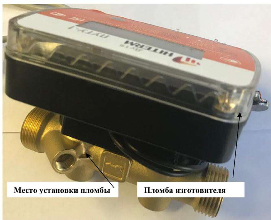
Рисунок 2 - Места пломбирования теплосчетчика ПУТУ-1
