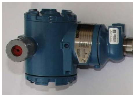
в) преобразователь давления 3051
